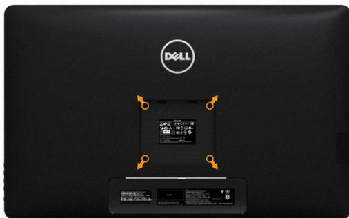
**NOTA:** Da utilizzare solo con supporti per installazione a parete omologati UL -con una capacità di peso/carico minima di 7,11 kg.
